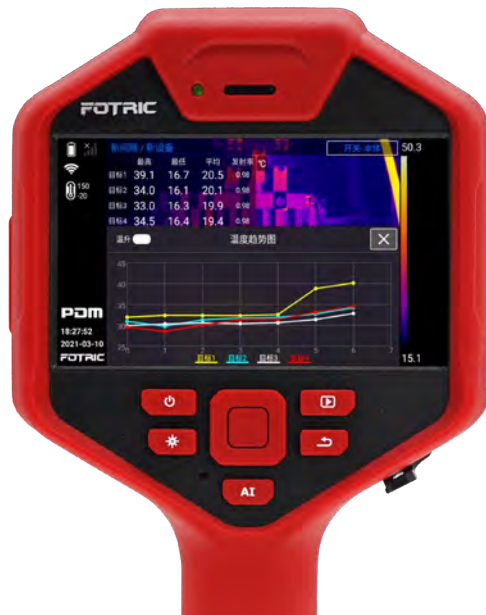
本机现场显示设备历史温升曲线
