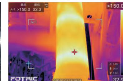
高炉热风管道检测
